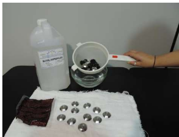
Fotografia ilustrando a limpeza de elementos táteis de alerta por imersão em álcool isopropílico.
