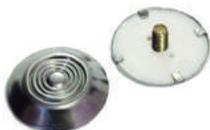
O Alerta Inox SoldaFix possui um substrato em termoplástico de alto impacto e capa de aço inoxidável, dotados de pino roscado feito em aço galvanizado e bicromatizado com comprimentos de 6 a 8mm (conforme espessura do carpete ou laminado). Indicados para ambientes internos, carpetados ou laminados, com alto tráfego de pessoas e fluxo moderado de carga.
