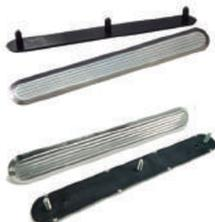
O elemento Direcional Pino Inox possui um núcleo de termoplástico revestido por uma capa de aço inox encaixada sob pressão e cravada mecanicamente no substrato. Na superfície do topo do sinalizador existem nervuras para aumentar a rugosidade com efeito antiderrapante. Como no alerta, há a opção também do pino metálico.
