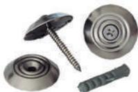
Este sinalizador tátil apresenta toda a sua superfície em aço inox e cavidade cônica para encaixe de um parafuso de aço inox A2 com comprimento de 32 mm (DIN EN ISO 7050). Acompanha buchas plásticas S6. A capa de aço inox encontra-se encaixada sob pressão e cravada mecanicamente no substrato. O substrato é inteiramente em termoplástico.
