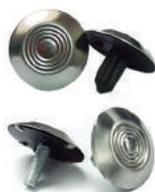
Os sinalizadores táteis Alerta Pino Inox da Mozaik são constituídos internamente por termoplástico revestido com uma capa de aço inoxidável. A capa de aço inox encontra-se encaixada sob pressão e cravada mecanicamente no substrato. Na superfície do topo do sinalizador existem nervuras para aumentar a rugosidade com efeito antiderrapante. Opção por pino metálico também disponível.
