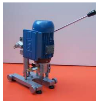
Perfuratriz 1 Furo Manual com broca diamantada
